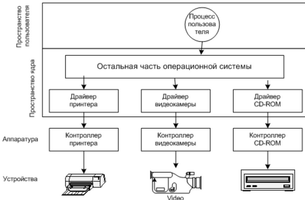
Логическое расположение драйверов устройств. На самом деле обмен данными между контроллерами и драйверами идет по шине.
